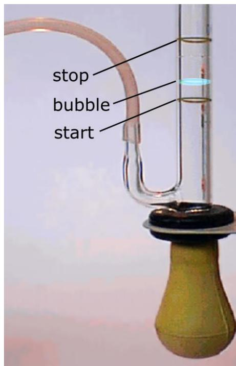
Fig. 38: Bubble flow meter
